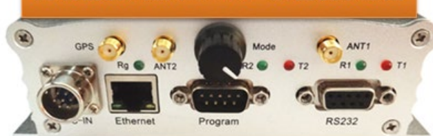
无线便携式基站NT787—后面板示意图
